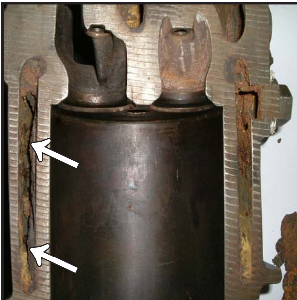
Motorzylinder verkalkt / Kolbenfresser
