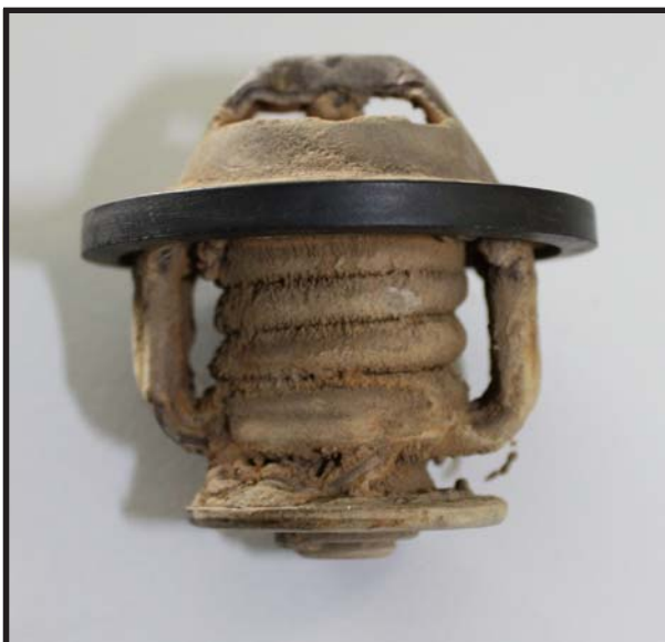
Thermostatventil verschlamm, verkalkt
